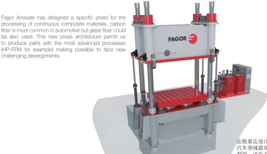
法格塞达设计了一款用于复合材料的连续加工的压力机。 汽车领域最常见的材料是碳纤维,但是玻璃纤维也可以 利用。该压力机的结构可以使用户采用最先进的生产工 艺(例如HP-RTM),来面对新工艺的挑战。
