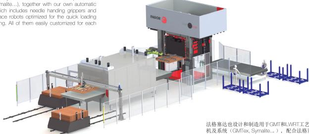
法格塞达也设计和制造用于GMT和LWRT工艺的成形压力 机及系统(GMTex, Symalite...),配合法格塞达技术的 全自动化系统,包括针型夹持器和经优化专门用于快速取 放料机器人。这些设备均根据客户的工艺量身定制。
