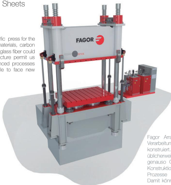
Fagor Arrasate hat eine spezielle Presse für die Verarbeitung von Material mit durchgehenden Fasern konstruiert. Im Automobilsektor handelt es sich hierbei üblicherweise um Carbonfasern, es können jedoch genauso Glasfasern verarbeitet werden. Diese neue Konstruktion ermöglicht uns die aktuell fortschrittlichsten Prozesse anzuwenden (HP-RTM beispielsweise). Damit können wir globale Lösungen liefern und öffnen zukünftigen Entwicklungen die Tore.
