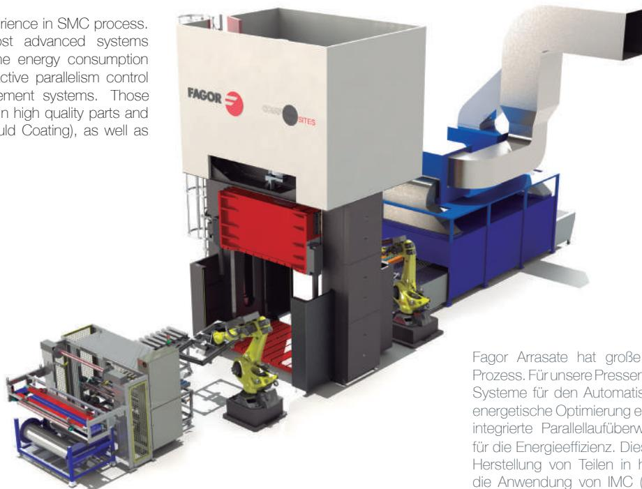
Fagor Arrasate hat große Erfahrung mit dem SMC-Prozess. Für unsere Pressen werden die fortschrittlichsten Systeme für den Automatisierungsprozess und dessen energetische Optimierung eingesetzt. Zu nennen sind die integrierte Parallelaufüberwachung und Regelsysteme für die Energieeffizienz. Diese Systeme ermöglichen die Herstellung von Teilen in höchster Qualität, außerdem die Anwendung von IMC (In Mould Coating) und eine Reduzierung des Energieverbrauchs.
